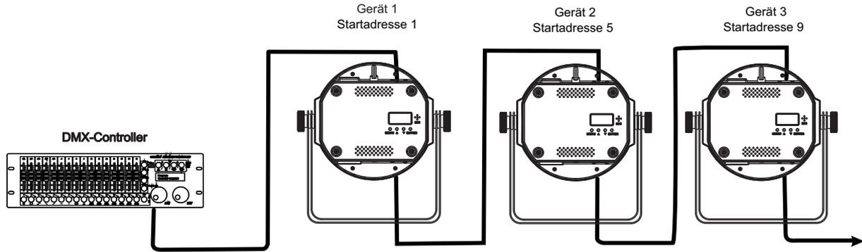
Für die Ansteuerung des Geräts per DMX512 ist eine Datenverbindung notwendig. Das Gerät verfügt dazu über 3-polige XLR-Anschlüsse.
